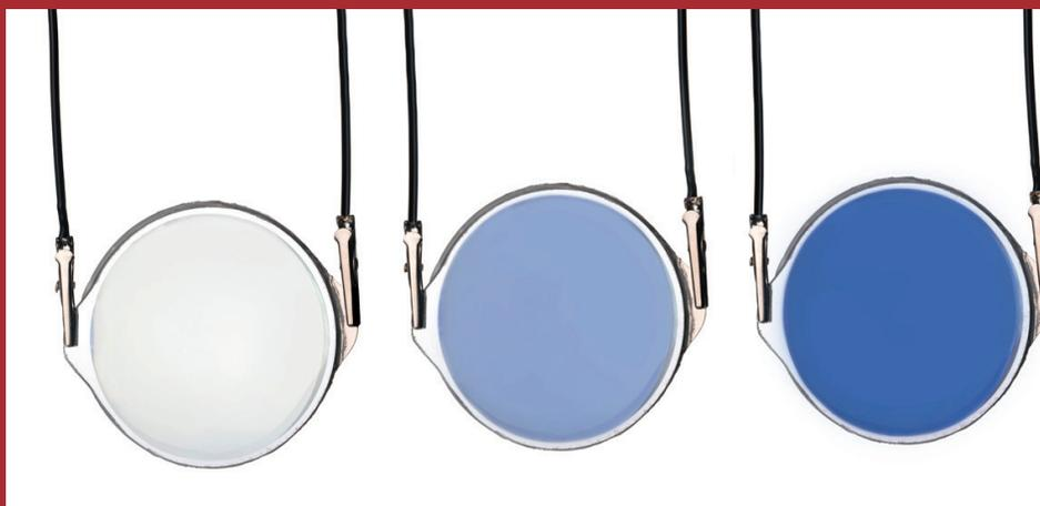
Spannung angelegt wird, ein Ladungs- und Ionenaustausch statt. Dieser sorgt dafür, dass sich die elektrochrome Schicht verfärbt bzw. wieder entfärbt. Eine wesentliche Rolle spielen dabei auch transparent-leitfähige Schichten sog. TCO-Schichten. Sie verbinden die aktiven Schichten mit dem Glas- oder Kunststoffsubstrat und versorgen sie mit der benötigten elektrischen Ladung.
