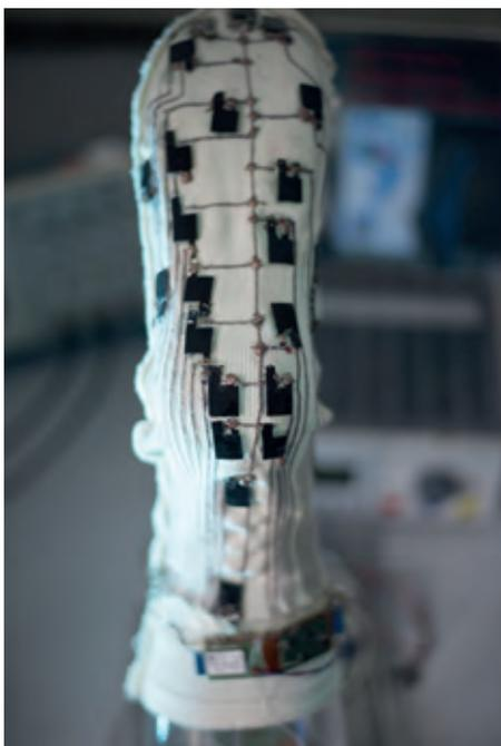
den Seiten der Folie. Dadurch entsteht ein elastischer Kondensator. Diese speziellen Flächenelektroden bestehen aus elektrisch leitfähigen Partikeln, die in eine elastische Matrix integriert sind. Bei Zugbelastung oder Verformung vergrößert sich die Oberfläche, während gleichzeitig die Dicke der Sensorfolie abnimmt. Die damit verbundene Kapazitätserhöhung wird als Messsignal weiterverarbeitet und lässt sich mit der Verformung korrelieren.
